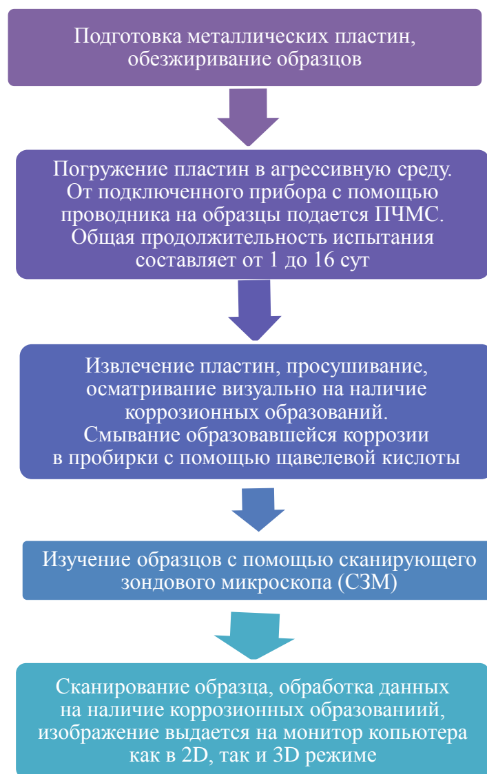
Рис. 7. Алгоритм определения коррозионного воздействия на металлы с помощью СЗМ
