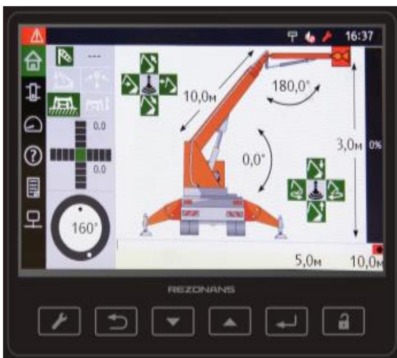
Рис. 6. Дисплей (блок индикации) пульта управления ППП-32(65225)
