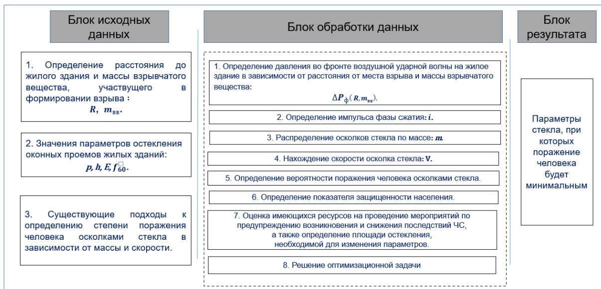
Рис. 1. Схема научно-методического аппарата методики определения обоснования рациональных параметров остекления для защиты населения от поражающих факторов взрыва при ЧС техногенного характера на ПОО
