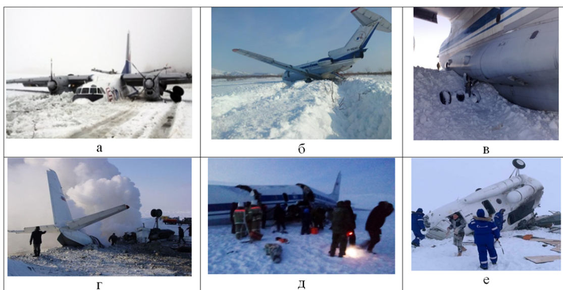
Рис. 5. Аварийные посадки самолётов (а-д) и вертолётов (е) в условиях низких температур
