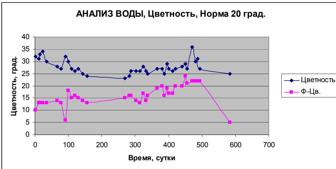
Рис. 4. Анализ воды «до» и «после» фильтра, «цветность»
