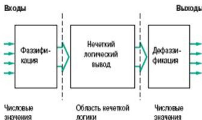
Рис. 1. Процесс обработки нечеткой логики
