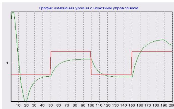
Рис. 5. Переходный процесс при  $H_0=1,5$  м и  $Hz=от 0,8$  м до  $1,2$  м
