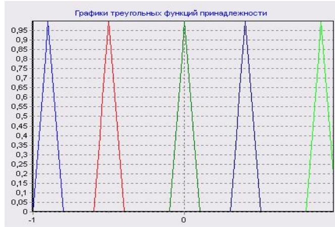
Рис. 3. Фазификация выходной переменной клапан
