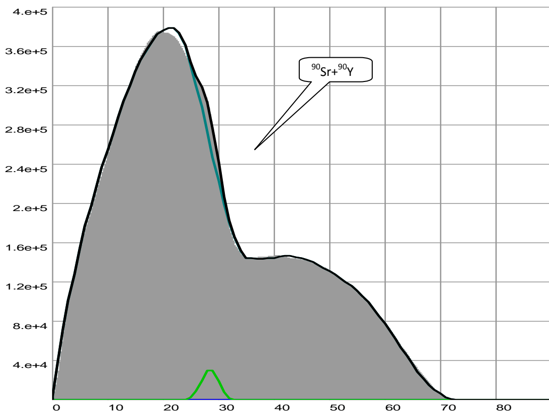
Рис. 4. Спектр бета-излучения счетного образца пробы
