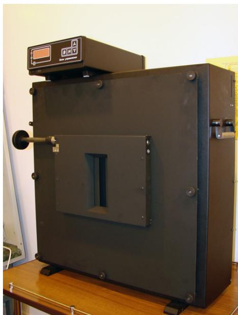
Рис. 3. Протяженный излучатель ПЧТ-540/40/100, «Эталон»
