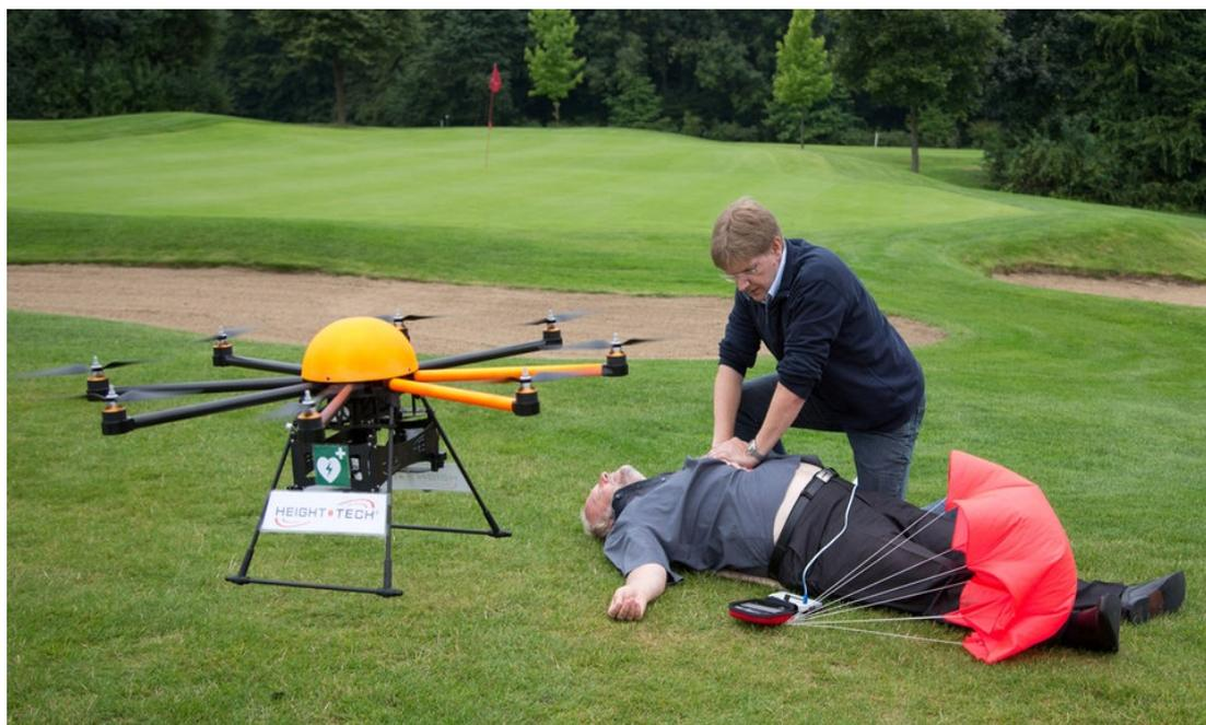
Рис. 2. «Летающий» дрон для доставки дефибриллятора (Германия)
