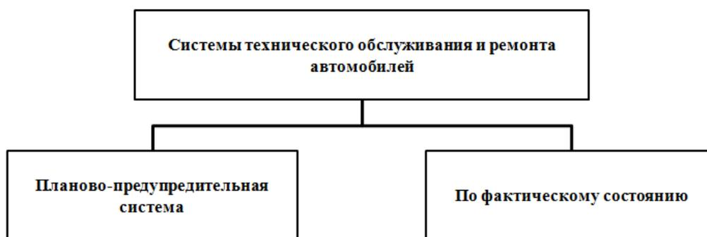
Рис. 1. Системы технического обслуживания и ремонта
