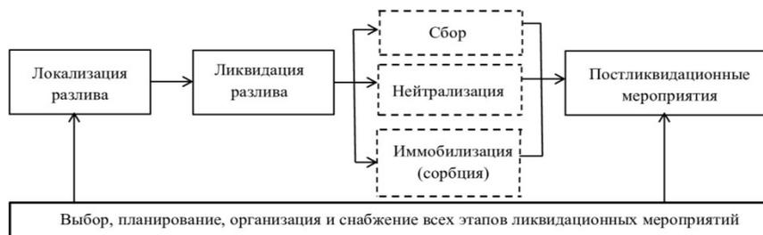
Рис. 1. Принципиальная технологическая схема локализации и сбора разливов нефтепродуктов на ЖДТ
