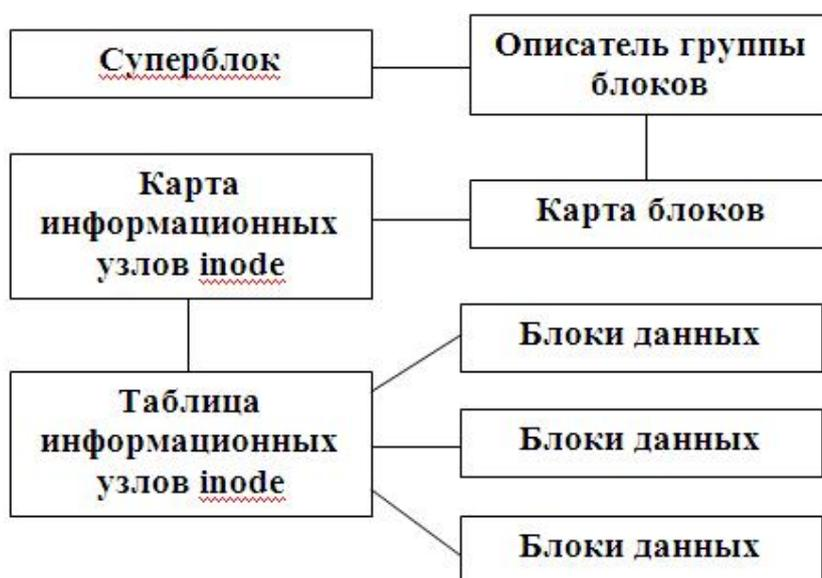
Рис. 2. Структура файловой системы ОС Linux
