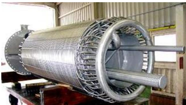
Рис. 3. Фотография витого (змеевикового) ТА
