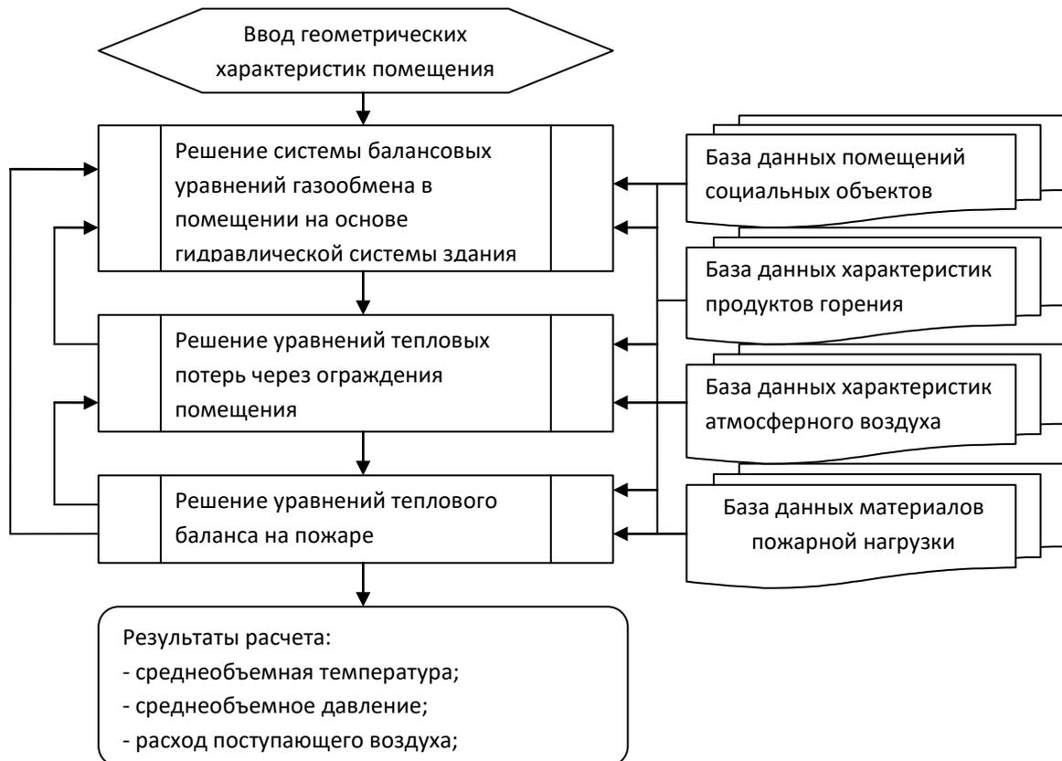
Рис. 2. Алгоритм интегральной модели пожара в ограждениях на социальном объекте
