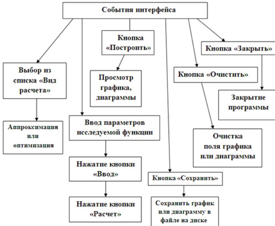
Рис. 5. Укрупненная схема обработки событий программы для ЭВМ
