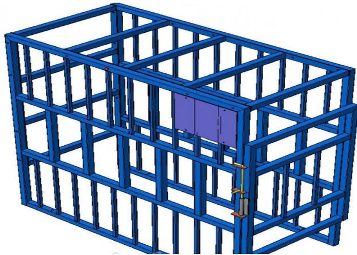
Рис. 5. Клеть для накачивания крупногабаритных колес мод. 506
