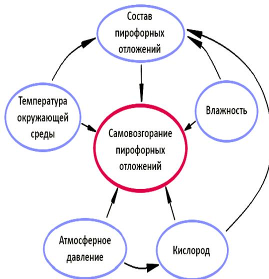
Рис. 2. Схема взаимодействия факторов процесса самовозгорания пирофорных отложений
