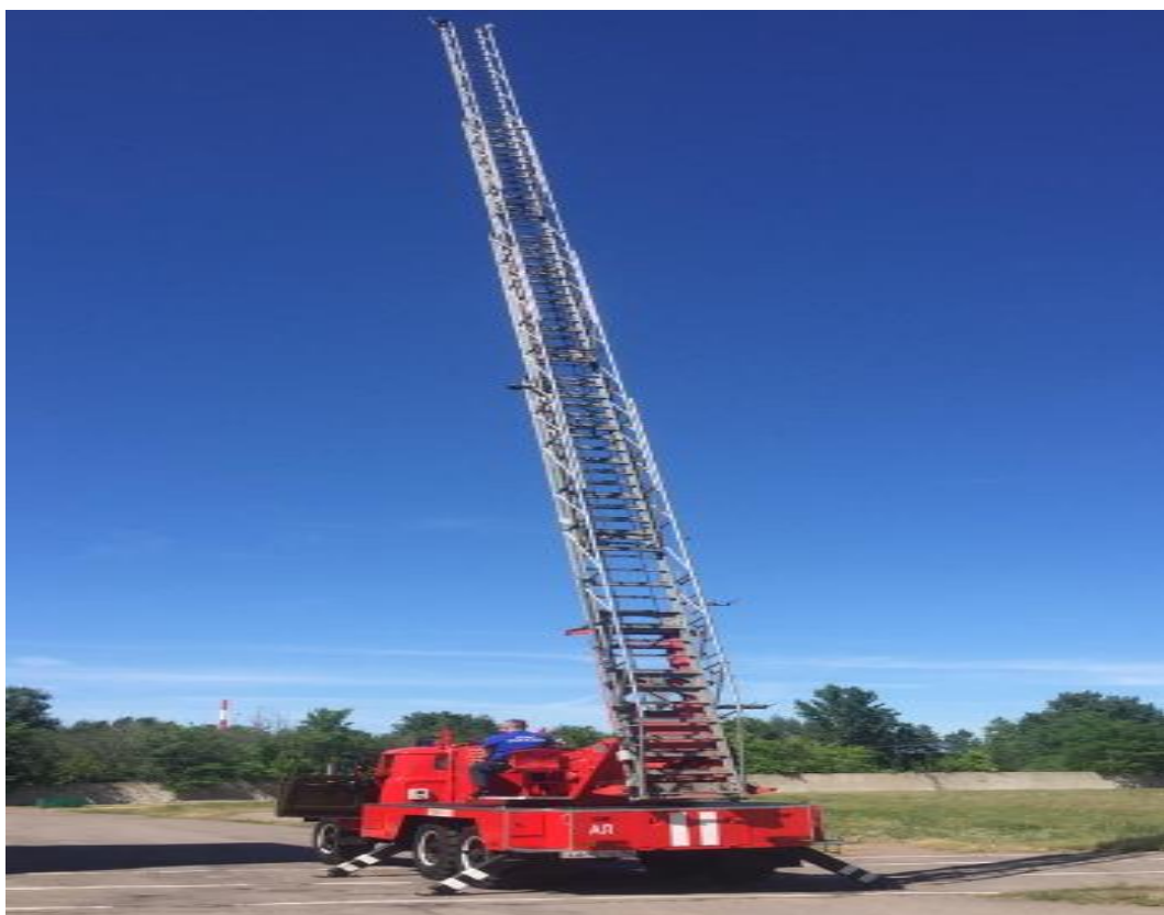
Рис. 3. Выдвижение лестницы АЛ-30 (131), не оборудованной съемной люлькой и лифтом, без нагрузки
