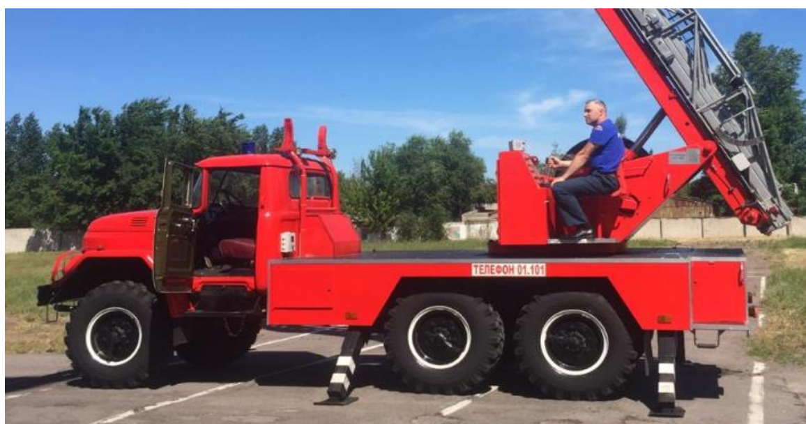
Рис. 2. Выдвижение опор АЛ-30 (131) на горизонтальной площадке
