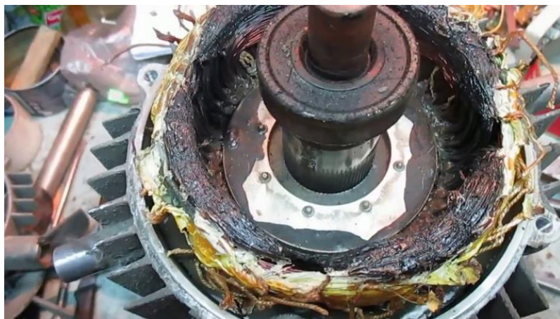
Рис. 4. Последствия перегрузки электродвигателя
