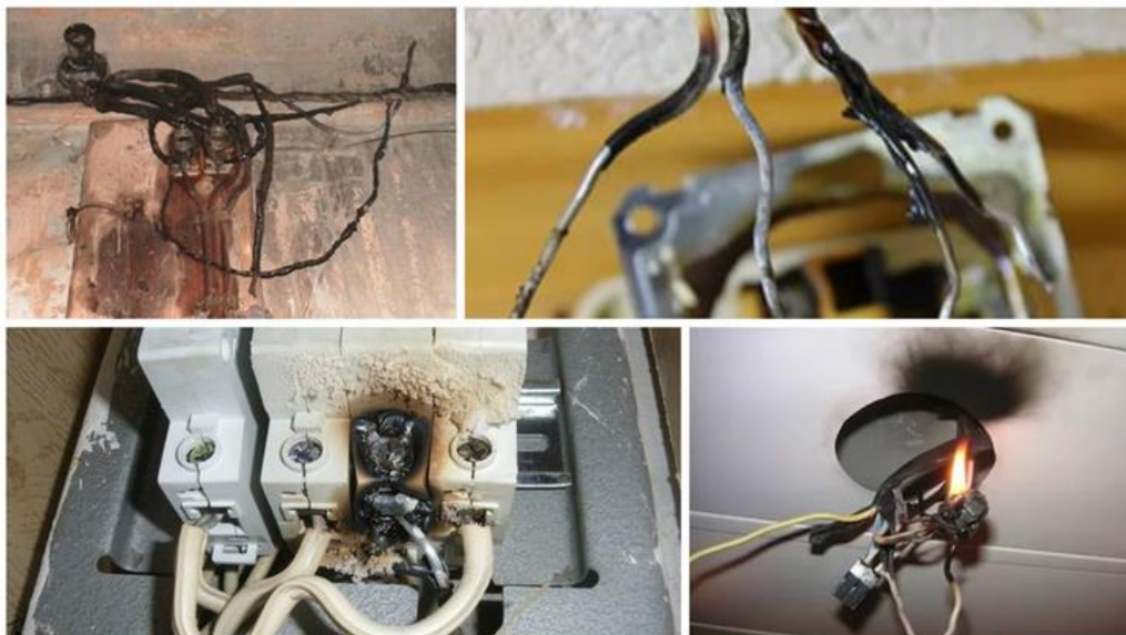
Рис. 5. Последствия возникновения повышенного переходного сопротивления
