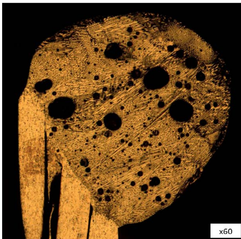
Рис. 5. Панорамное изображение микроструктуры оплавления образца, полученного с помощью сварочного аппарата
