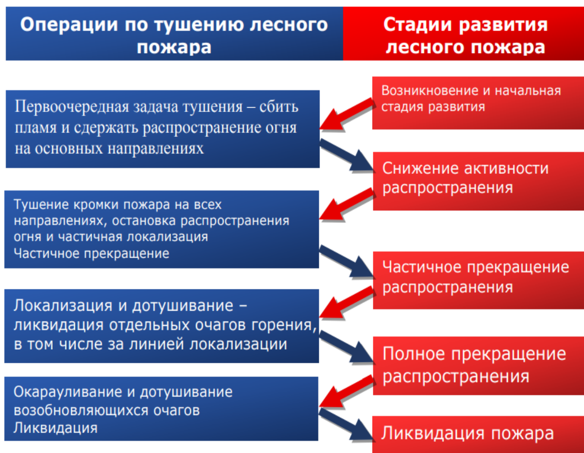
Рис. 2. Стадии развития пожара и операции по тушению пожара
