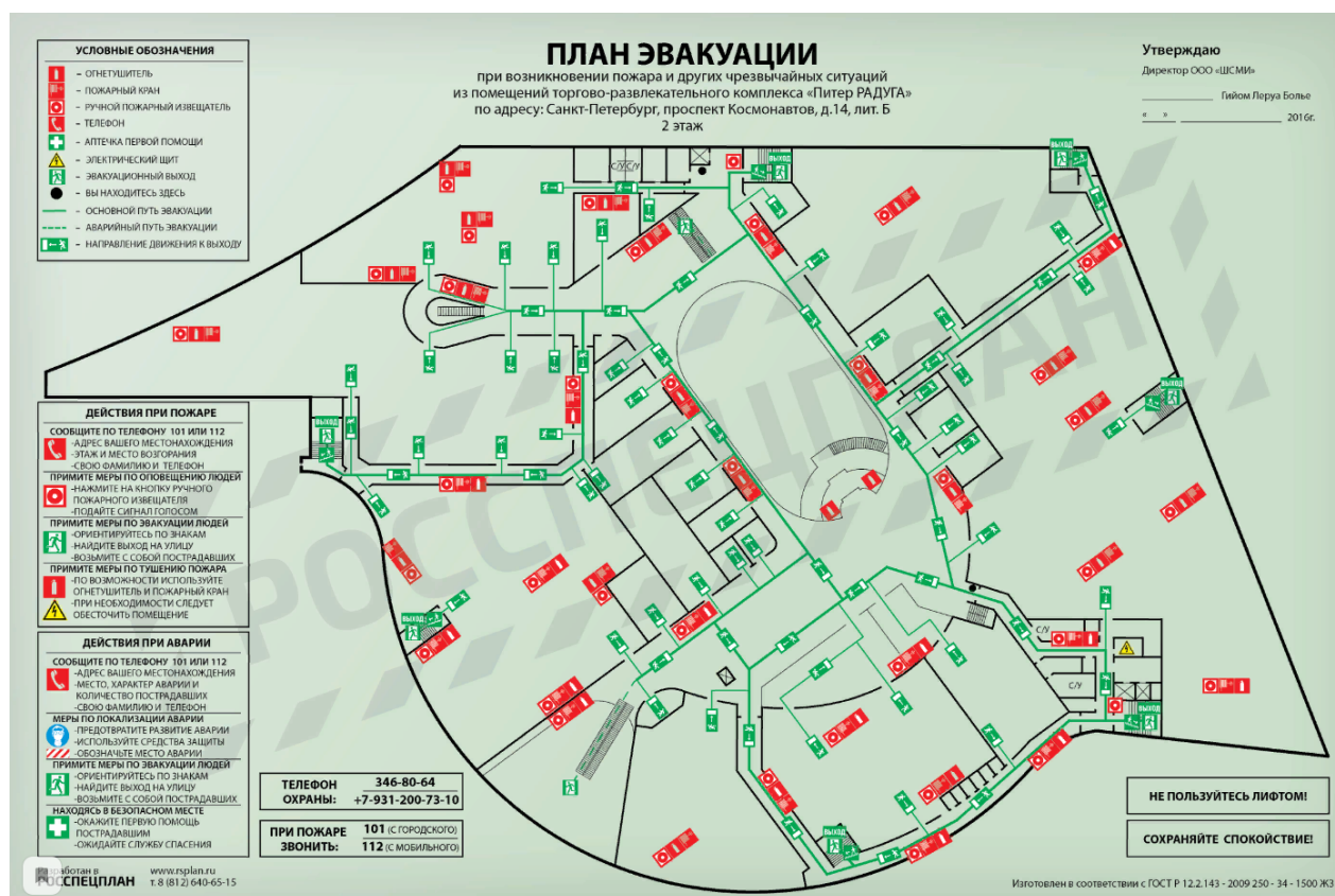
Рис. 5. План эвакуации при возникновении пожара со второго этажа ТРЦ «Питер Радуга»
