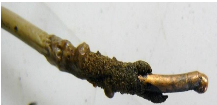
Рис. 1. При КЗ и в отсутствии дальнейшего термического воздействия сохраняется изоляция с признаками термической деструкции с внутренней стороны
