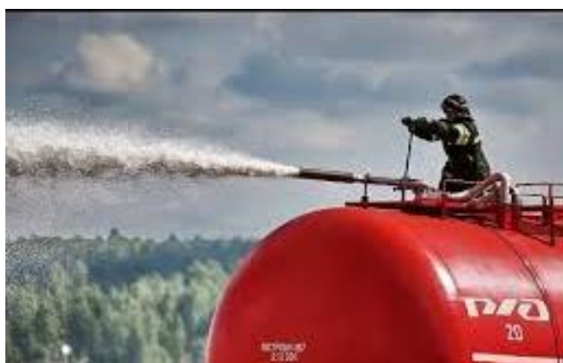
Рис. 3. Лафетный ствол, управляемый оператором на водяной цистерне, интенсивность подачи 40 л/с, дальность тушения до 25 м
