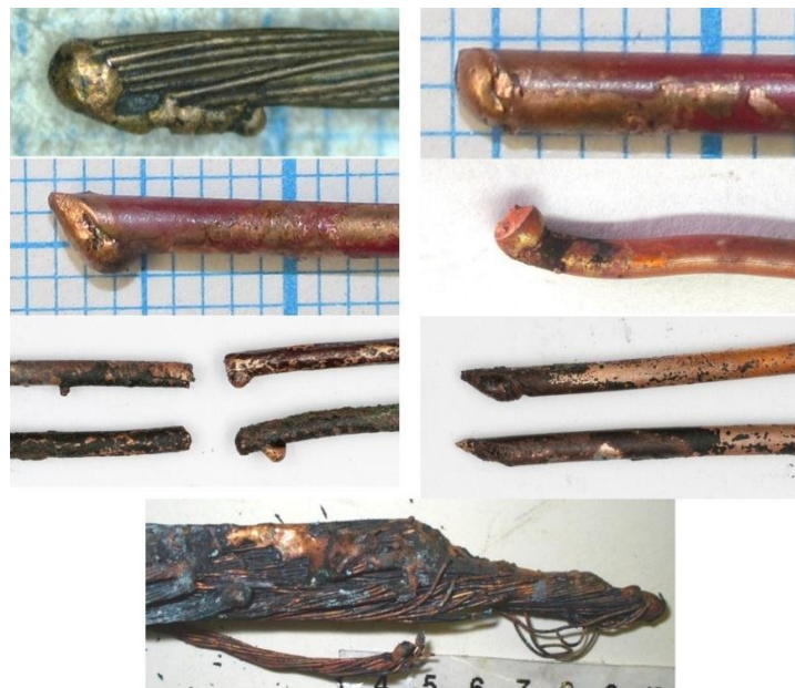
Рис. 2. Разновидности оплавлений медных проводников при КЗ
