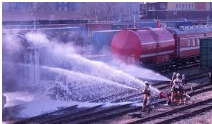
Рис. 4. Ручные стволы, питаемые из водяной цистерны и управляемые операторами, интенсивность подачи 20 л/с, дальность тушения горящих нефтепродуктов до 15 м
