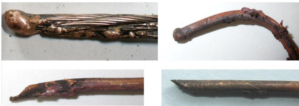
Рис. 5. Разновидности оплавлений медных проводников при КЗ
