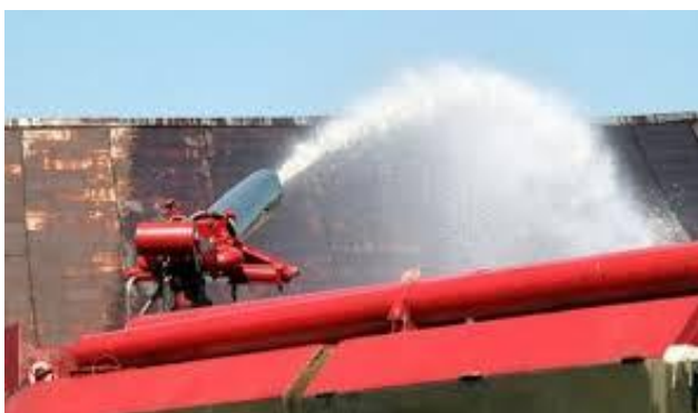
Рис. 2. Цистерна с дистанционно управляемым лафетным стволом интенсивностью подачи пены 20 л/с, дальность тушения до 15–20 м
