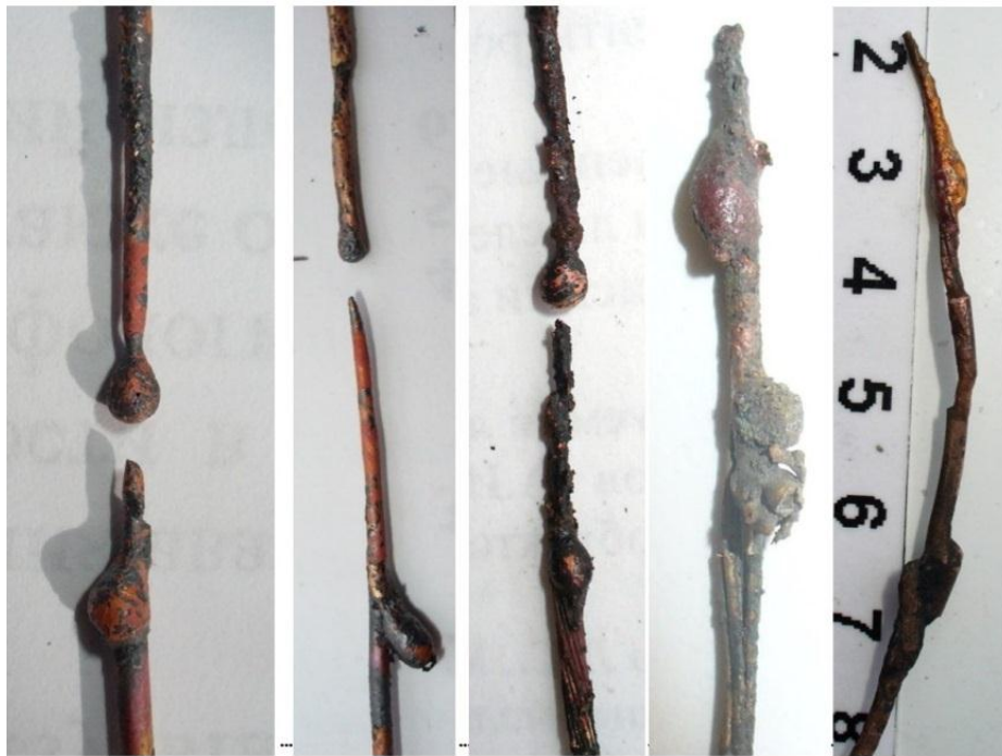
Рис. 8. Разновидности оплавлений медных проводников, находящихся в вертикальном положении при электродуговом процессе КЗ
