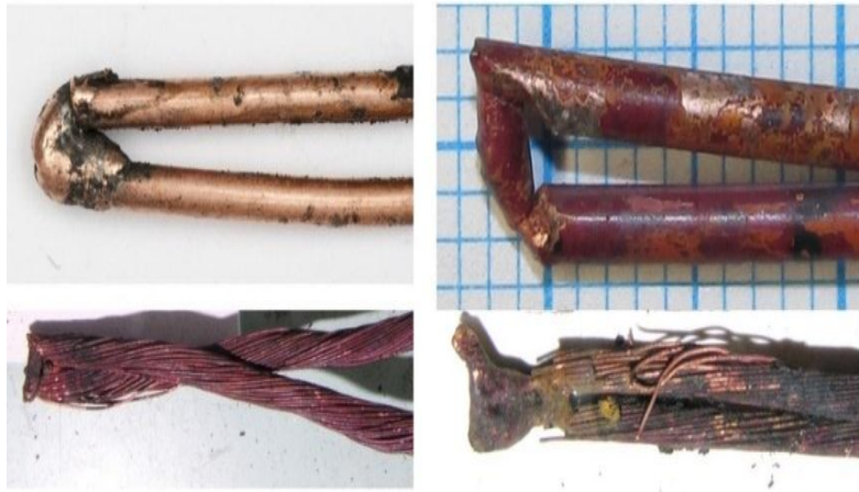
Рис. 4. Морфология сплавлений двух медных проводников при КЗ
