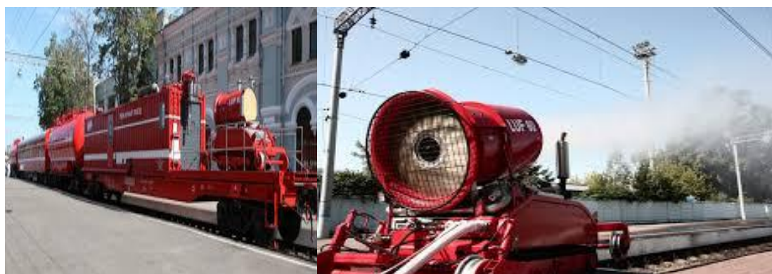
Рис. 5. Пожарный поезд с платформой, на которой размещены пожарный модуль с насосами, электрогенератор для питания робота с пеногенератором LUF-60 на дрезине, интенсивность подачи 60 л/с, дальность тушения разлива нефтепродуктов до 25 м
