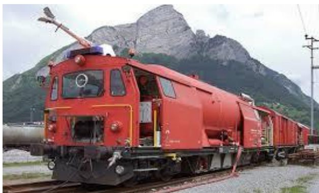
Рис. 1. Локомотив с цистерной и дистанционно управляемым из кабины лафетным стволом, подающим воду 70 л/с, дальность тушения до 35–40 м
