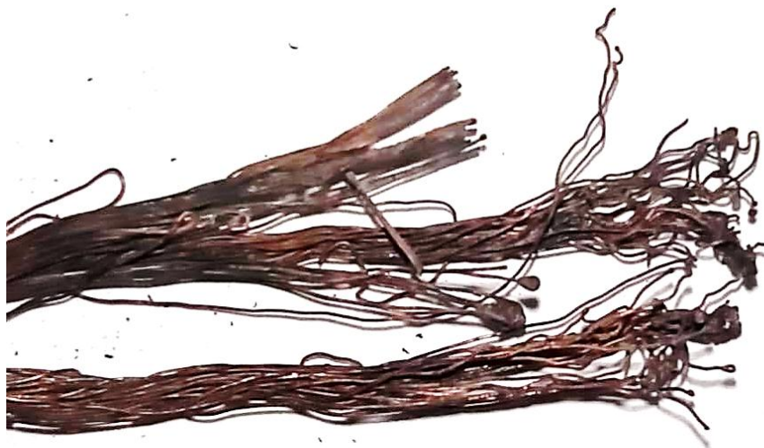
Рис. 9. Оплавления на отдельных проволоках медного многопроволочного проводника при последовательном дуговом пробое
