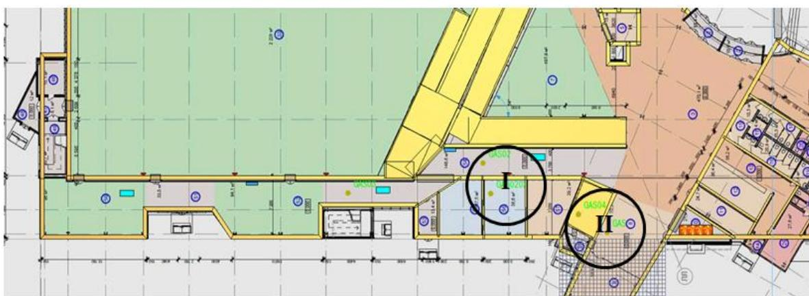
Рис. 8. Коридор, защищенный противодымной вентиляцией
