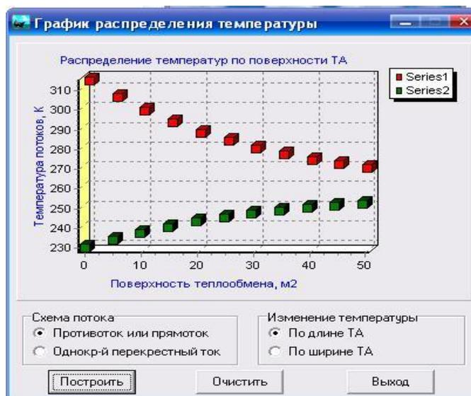
Рис. 4. Распределение температур при прямотоке
