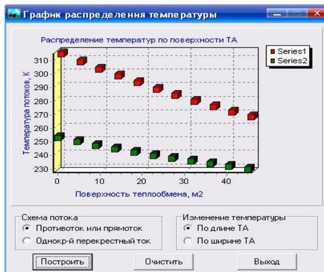
Рис. 3. Распределение температур при противотоке
