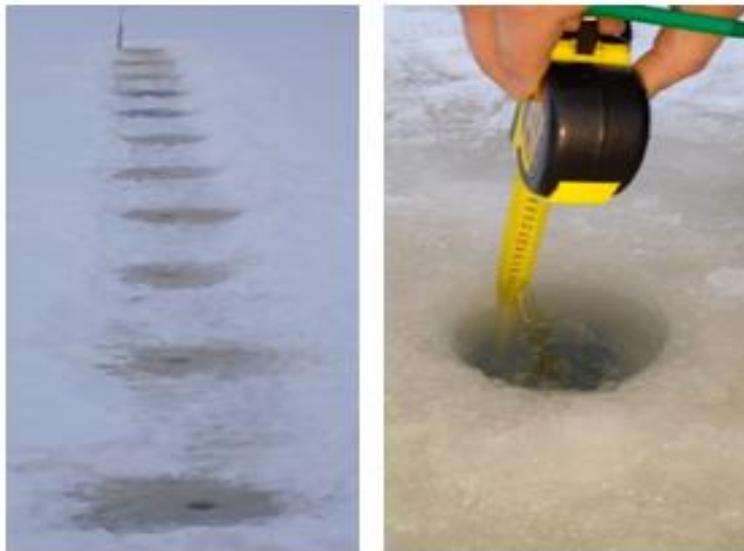
Рис. 2. Производство лунок и измерение толщины ледяного покрытия водоема
