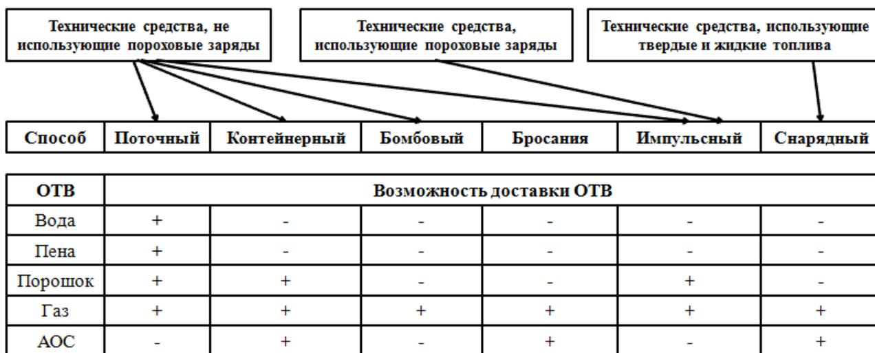
Рис. 5. Классификация способов доставки ОТВ (доставка обеспечивается (+), доставка не обеспечивается (-))
