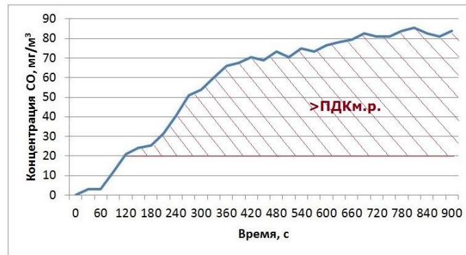
Рис. 5. Изменение концентрации CO в течение 15 мин без активации оросителя
