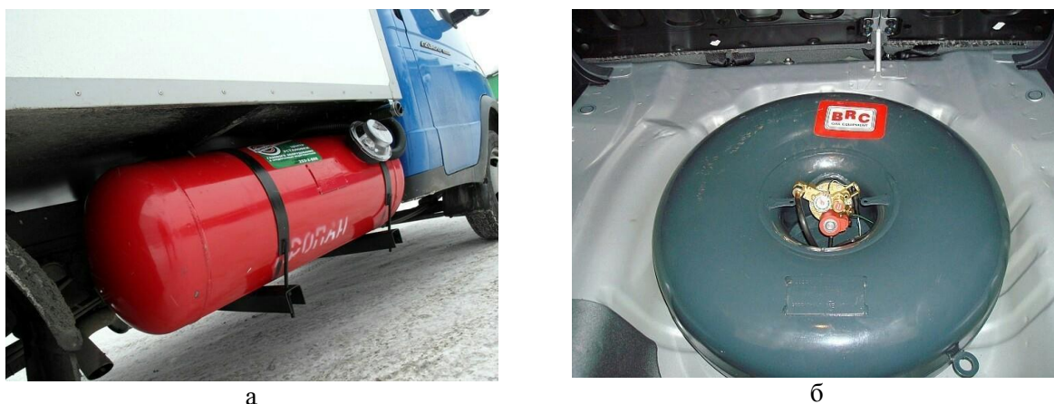
Рис. 4. Газобаллонные автомобили: а) полностью газобаллонный; б) тороидальный газовый баллон в багажнике автомобиля с комбинированным ДВС
