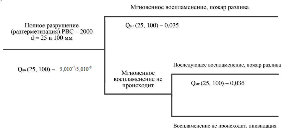
Рис. 2. «Дерево событий» для аварийной ситуации, вызванной разрушением (разгерметизацией) наземной емкости с легковоспламеняющейся жидкостью на открытой местности
