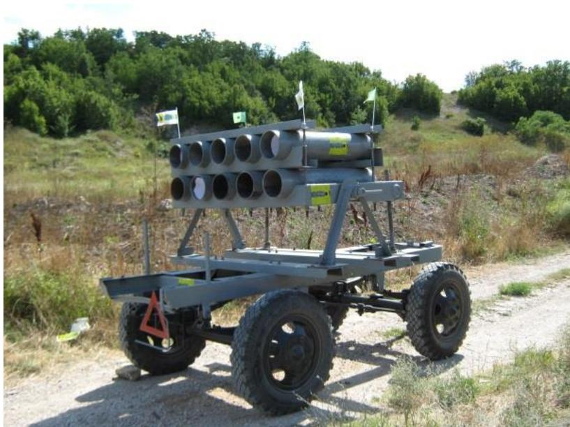
**Рис. 1. Многоствольный модуль, успешно прошедший испытания для ликвидации последствий разлива в Керченском проливе (2007 г.)**
