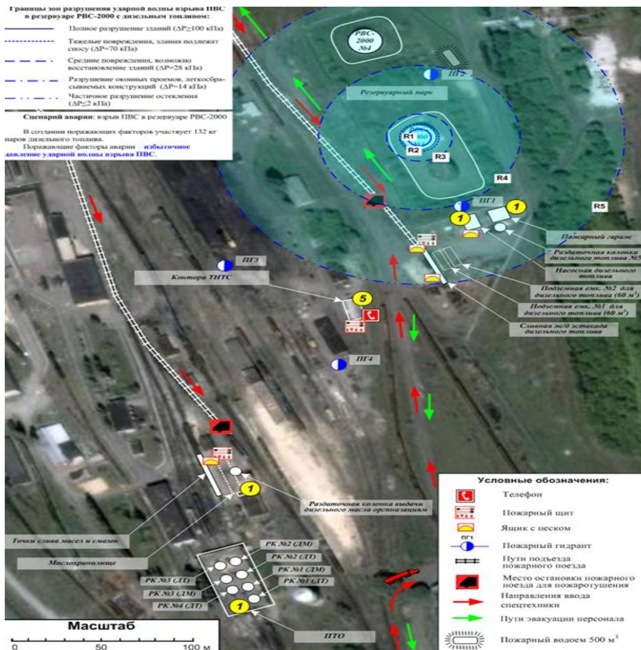
Рис. 4. Зоны возможного поражающего фактора (ударная волна взрыва) при взрыве газозвушных смесей
