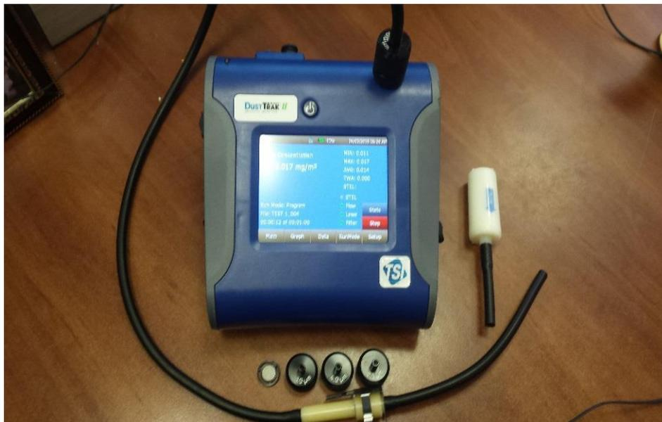
Рис. 2. Анализатор *DUSTTRAK 8530* с устройством отбора частиц и четырьмя сменными элементами фильтрации частиц  $PM_{10}$ ,  $PM_4$ ,  $PM_{2,5}$  и  $PM_1$
