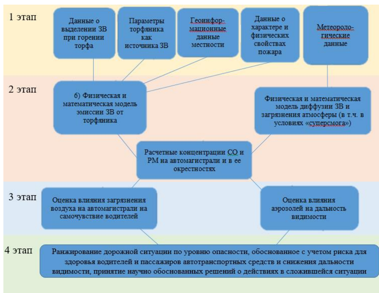
Рис. 2. Структурно-логическая схема информационного процесса прогнозирования ЧС на автомобильной трассе, находящейся в зоне действия продуктов горения торфяного пожара (ЗВ – загрязняющее вещество)
