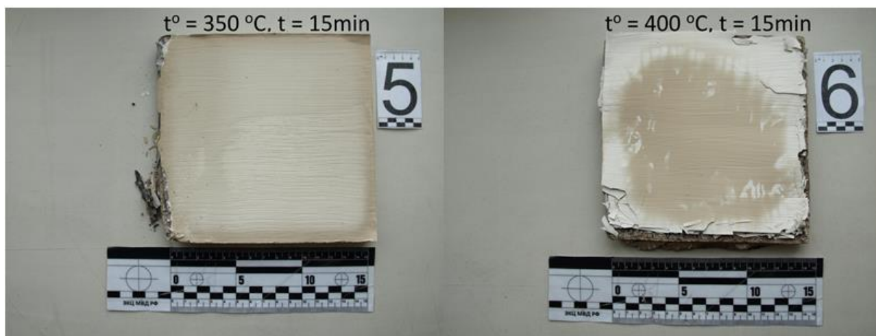
Рис. 2. Образцы, выдержанные при 350 °С и 400 °С
