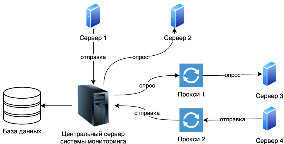
Рис. 1. Архитектура системы мониторинга ГРИС
