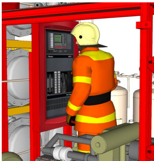
Рис. 5. Блок управления УУПТ с вытеснением ОТВ газопоршневым способом
