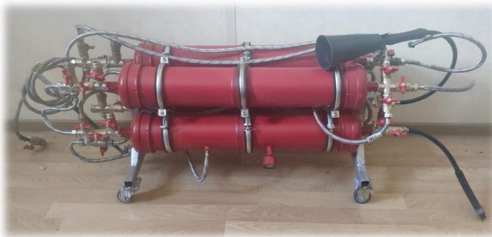
Рис. 1. Внешний вид макета экспериментальной УУПТ с вытеснением ОТВ газопоршневым способом
