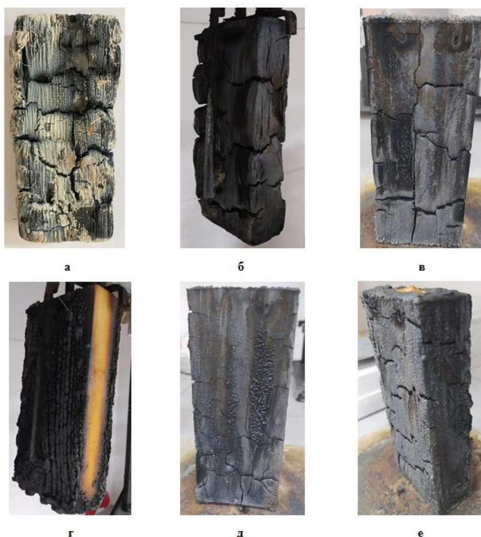
Рис. 1. Фото образцов древесины после испытаний по ГОСТ Р 53292–2009: а – 1; б – 2; в – 3; г – 4; д – 5; е – 6 (номера образцов представлены в табл. 1)
