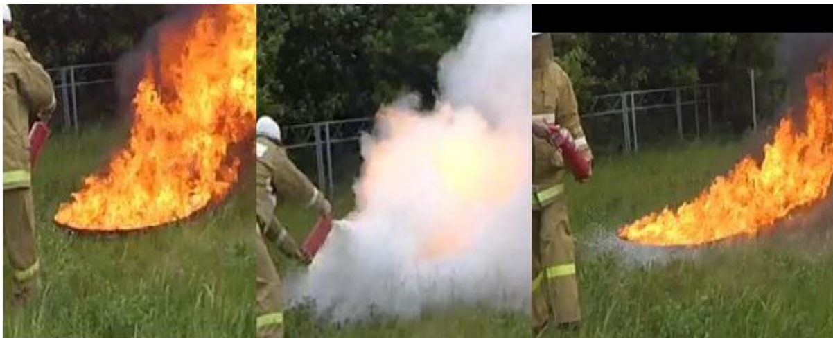
Рис. 1. Плотное облако инертной пыли без действующего вещества (не всегда может затушить пожар в нормативных условиях)
