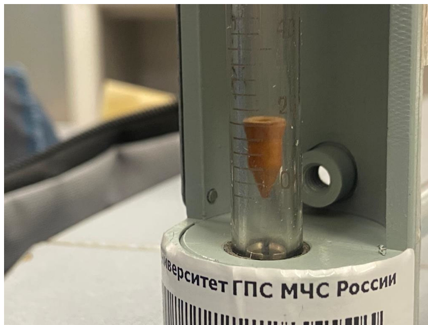
Рис. 3. Объёмный расход D_{1Y} электролизера, измеренный ротаметром РМ-А-0.063 ГУЗ
