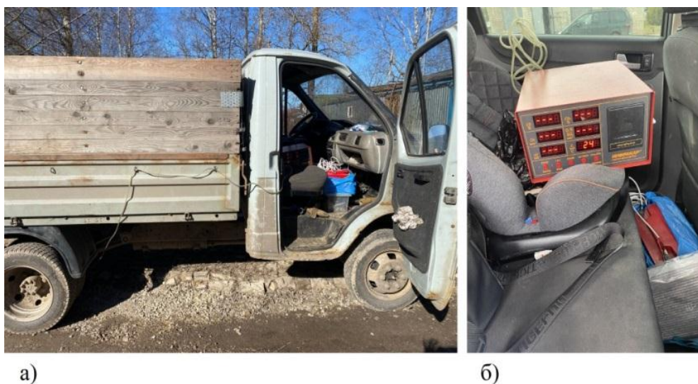
Рис. 1. Замер концентраций поллютантов с использованием газоанализатора «Инфраклар 5МЗТ.02Л» в отработавших газах: а) автофургона ГАЗ 33021; б) легкового автомобиля Ford Focus (Санкт-Петербург, март–апрель 2024 г.)
