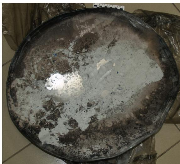
Рис. 2. Крышка от металлической бочки, поступившей на исследование, с остатками вещества светло-серого цвета
