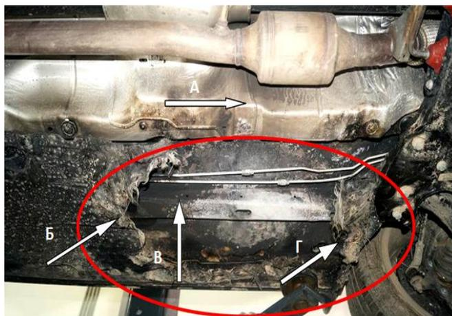
Рис. 2. Экспертиза автомобиля после пожара: красный овал – выгорание пластиковой защиты и шумоизоляционного покрытия; А – копоть слева (по ходу движения) от катализатора; Б – выгорание шумоизоляционного покрытия; В – средний левый лонжерон и две тормозные магистрали (трубки) отожжены (имеют белый цвет); Г – фрагменты сухой травы и песка под сгоревшими деталями (источник: <http://avtotehexpert.ru/nashi-avtoekspertizy/vozgoranie-avtomobilya-ot-katalizatora-99/>)
