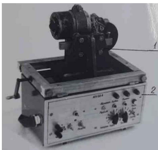
Рис. 1. Электромеханический привод (1) и электронный блок управления (2) перемещения РТН
