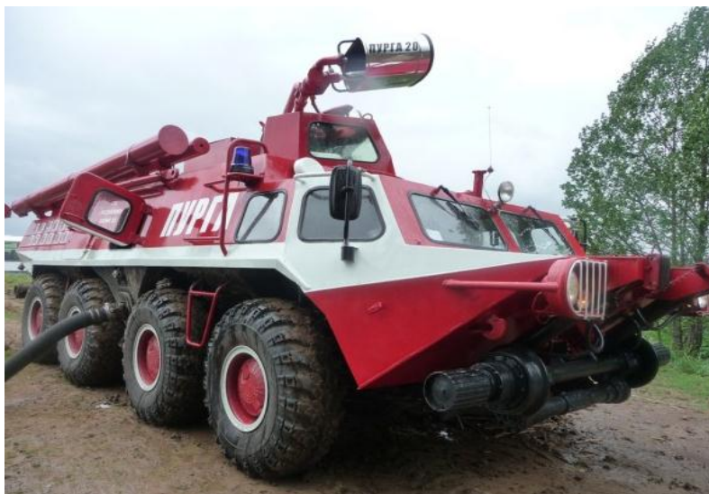
Рис. 4. Пожарная машина ГАЗ-59402 «Пурга» на комбинированном ходу ( https://portal.edufire37.ru/articles/140 )
