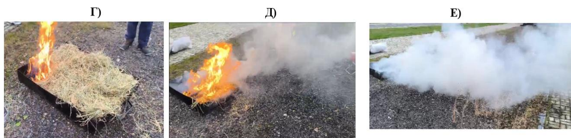
Рис. 3. Замер содержания аэрозолей в дыму во время горения образцов 1 и 4: А, Г – инициация горения; Б, Д – пламенное горение; В, Е – тление
