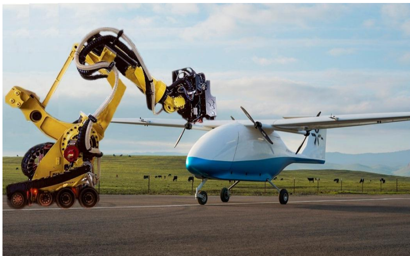
Рис. 1. Пример использования РАТЗ для заправки беспилотного летательного аппарата производства Pelican Cargo ( https://www.flypyka.com/pelican-cargo )
