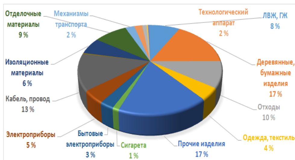
Рис. 3. Диаграмма процентного соотношения источников возгорания при строительстве, утилизации и проведении ремонтно-восстановительных работ на судах
