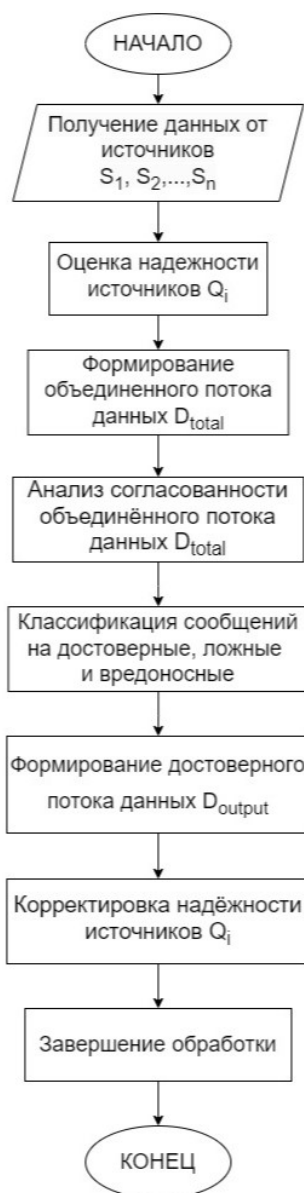
Рис. Блок-схема алгоритма для реализации метода комплексированной обработки данных с целью формирования и предоставления достоверной информации
