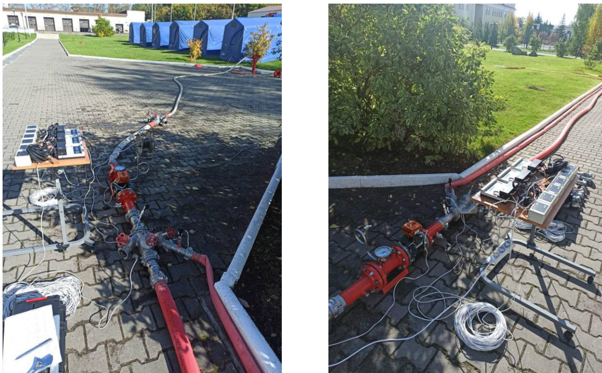
Рис. 5. Общий вид реализованной схемы, использованной для получения экспериментальных значений гидравлических сопротивлений патрубков РТ-80
