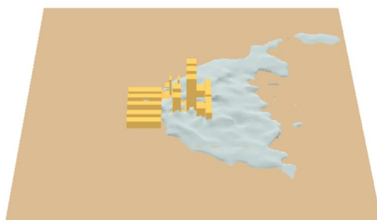
Рис. 9. Изоповерхность «газовая среда температурой от -60\text{ }^{\circ}\text{C} и ниже» через 55 с после начала разлива СПГ объемом 34\text{ м}^3 на производственной площадке. Размер выделенной области 60\times 60\text{ м} , размер производственной площадки 25\times 38\text{ м} . Начальная температура СПГ: -161,5\text{ }^{\circ}\text{C} . Температура окружающей среды: +18\text{ }^{\circ}\text{C} . Скорость ветра: 5,4\text{ м/с} . Влажность воздуха: 5,2\text{ }\%
