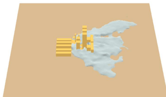
Рис. 7. Изоповерхность «газовая среда температурой от -60\text{ }^{\circ}\text{C} и ниже» через 35 с после начала разлива СПГ объемом 34\text{ м}^3 на производственной площадке. Размер выделенной области 60\times 60\text{ м} , размер производственной площадки 25\times 38\text{ м} . Начальная температура СПГ: -161,5\text{ }^{\circ}\text{C} . Температура окружающей среды: +18\text{ }^{\circ}\text{C} . Скорость ветра: 5,4\text{ м/с} . Влажность воздуха: 5,2\text{ }\%
