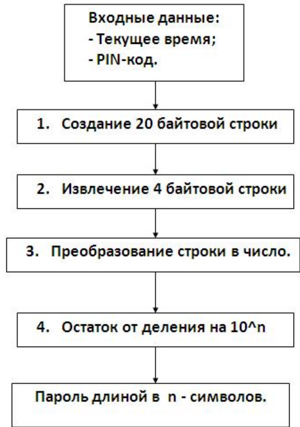
Рис. Блок-схема алгоритма генерации пароля
