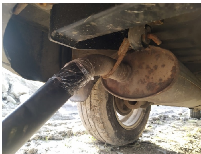
Рис. 4. Способ подвода выхлопных газов к пенному стволу
