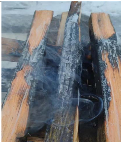
Рис. 1. Плёнка на поверхности очага класса А, образованная при тушении водным раствором сульфонола
