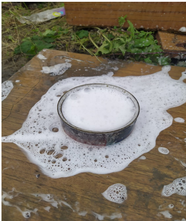
Рис. 5. Слой газонаполненной пены на поверхности очага
