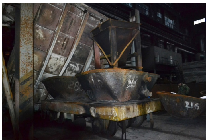
Рис. 7. Троллейная телега со сверхнормативной по высоте «двухъярусной» загрузкой
