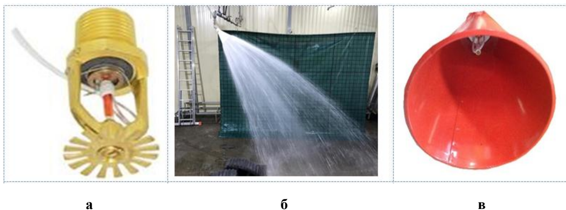
Рис. 3. Спринклерный ороситель «Аква-Гефест» с принудительным пуском (а), его испытания (б) и формирователь потока КФСТ 714171 (в)
