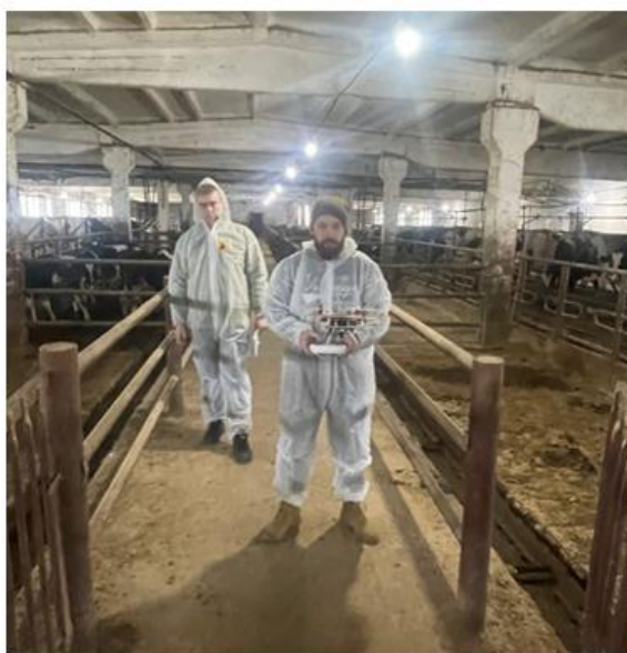
Рис. 3. Измерение концентраций газов ( \text{CH}_4 , \text{NH}_3 , \text{H}_2\text{S} , \text{CO}_2 ) прототипом на уровне 1,5 м (уровень органов дыхания)
