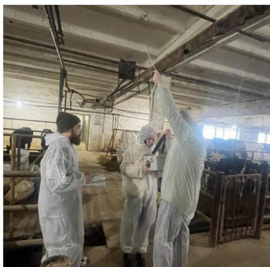
Рис. 4. Измерение параметров газов ( \text{CH}_4 , \text{NH}_3 , \text{H}_2\text{S} , \text{CO}_2 ) поверенным прибором ГАНК-4 на уровне более 2 м
