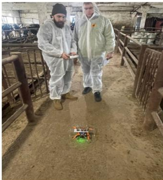
Рис. 2. Измерение концентраций газов ( \text{CH}_4 , \text{NH}_3 , \text{H}_2\text{S} , \text{CO}_2 ) прототипом на приземистом уровне до 0,5 м
