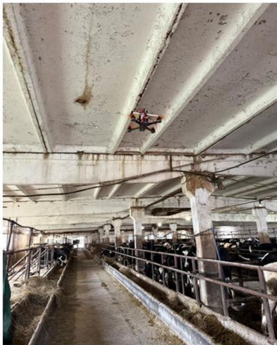
Рис. 5. Измерение параметров газов ( \text{CH}_4 , \text{NH}_3 , \text{H}_2\text{S} , \text{CO}_2 ) прототипом на уровне 4 м
