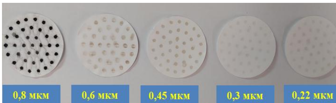
Рис. 5. Черный углерод (сажа) размером 0,8–0,22 мкм, осаждённая на мембранном фильтре типа МФАС – ВА отверстиями диаметром от 0,8 до 0,22 мкм производства ЗАО НТЦ «Владипор» (угольный концентрат, марка Д, место отбора – Тугнуйская обогатительная фабрика (Олонь-Шибирское и Никольское месторождение)
