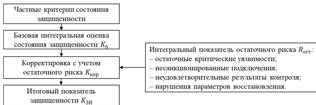
Рис. 1. Структурная схема формирования показателя защищенности
