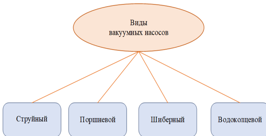
Рис. 1. Виды рассматриваемых вакуумных насосов
