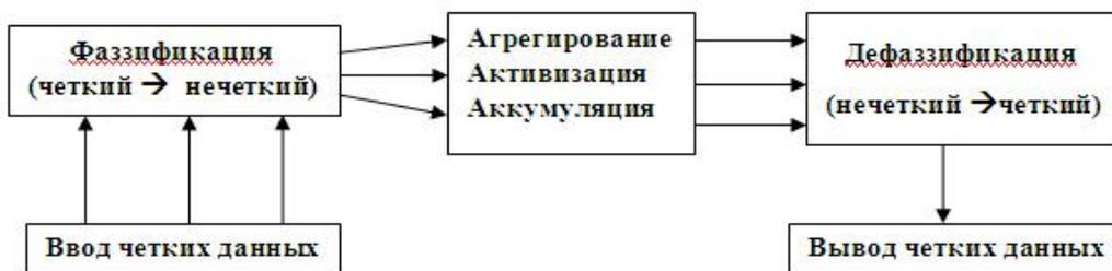
Рис. 5. Схема логики работы системы нечеткого вывода
