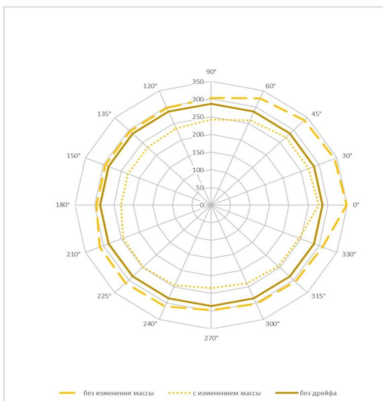
Рис. 5. Изолиния потенциального риска  $10^{-6}$  при аварийной ситуации, связанной с возникновением воздушной ударной волны при взрыве топливно-воздушной смеси
