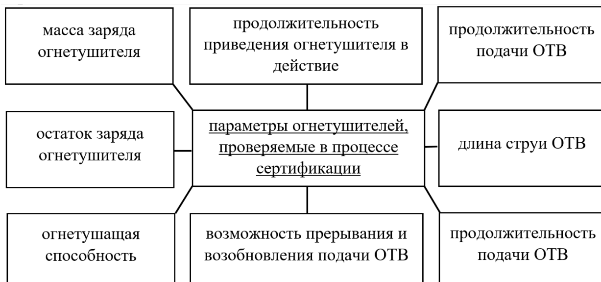
Рис. 2. Перечень характеристик, проверяемых при сертификации огнетушителей
