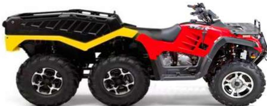
Рис. 2. StelsATV-600 с модулем повышения проходимости и грузоподъемности
