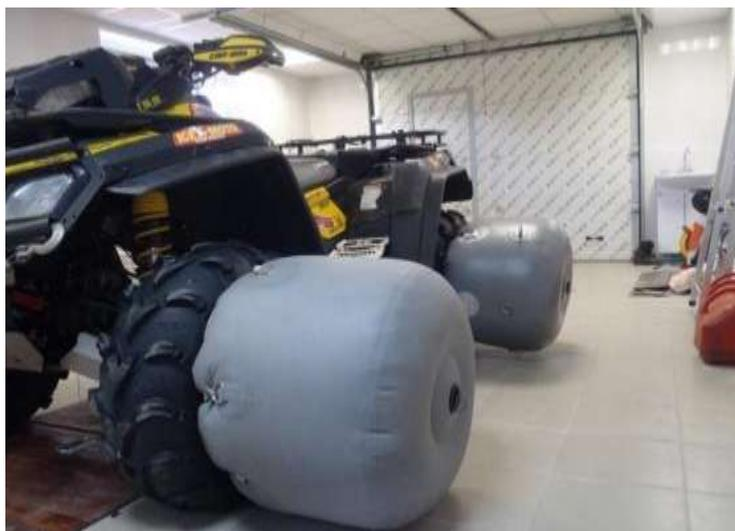
**Рис. 5. Надувные поплавки-баллоны**
