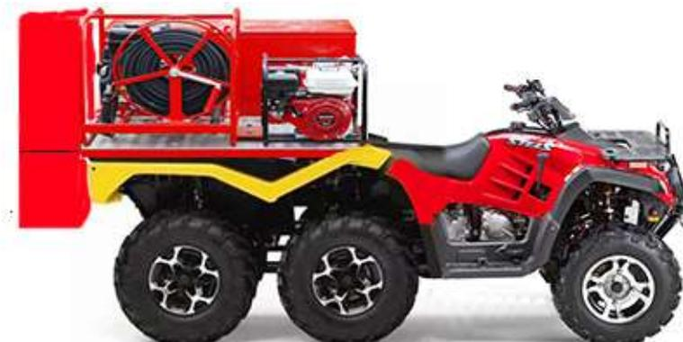
**Рис. 4. Варианты компоновки технического комплекса модулем УПМ-300 с дополнительной емкостью для воды**
