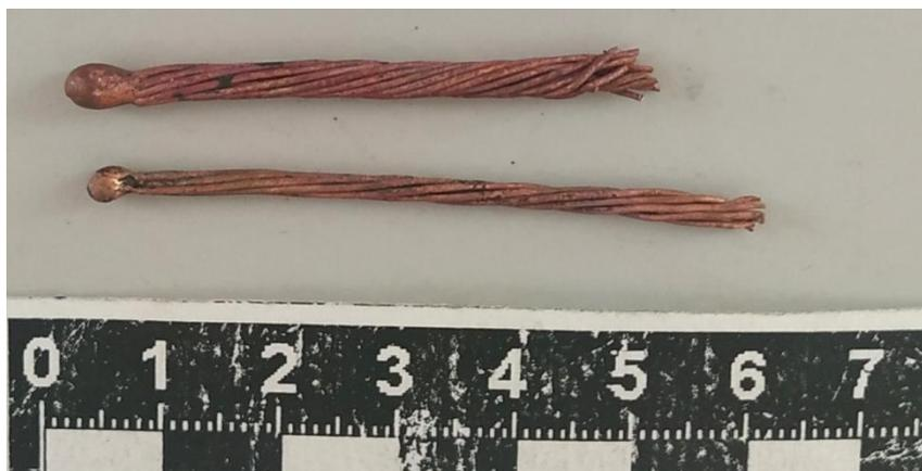
Рис. 2. Медные проводники с оплавлениями, отобранные для РФА
