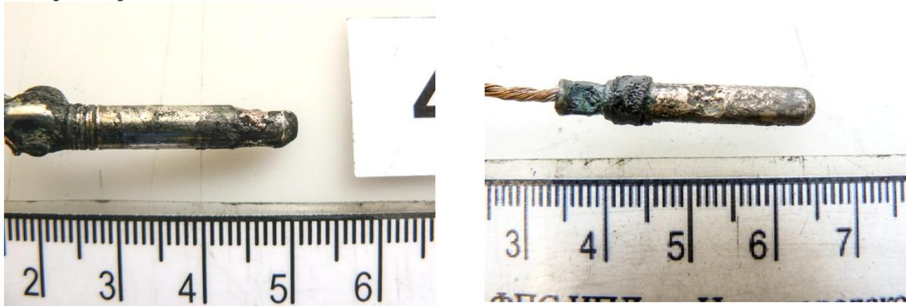
Рис. 3. Разрушения штырей вилок в результате протекания искрового режима БПС
